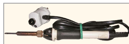
Рис. 4. Японский паяльник с керамическим нагревателем мощностью 15 Вт (лампа NE-2В – 3,8 \times 10 мм, R3-СП4-1 – 33 кОм)
