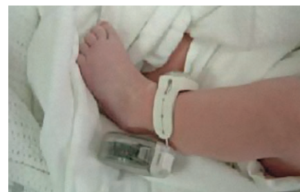
Рис. 2. Система, предназначенная для предотвращения похищений или подмены младенцев в детской больнице
