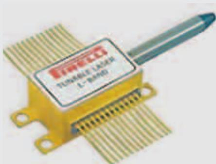
Полное решение Pirelli включает в себя динамически подстраиваемый лазер (dynamically tunable laser, DTL), интегрируемый модуль подстраиваемого лазера (integrable tunable laser assembly, ITLA) и 300-контактные MSA-транспондеры. Решение обеспечивает полное перекрытие L-диапазона (ширина диапазона 40 нм,
