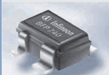
Серия HBT BFP740 производится крупными партиями и предлагается в следующих вариантах корпусов: Standard-SOT343 (BFP740), Flatlead-TSFP-4 (BFP740F) и в миниатюрном безвыводном корпусе TSLP-3 (BFR740L3), размеры которого составляют  $1 \times 0,6 \times 0,4$  мм.
