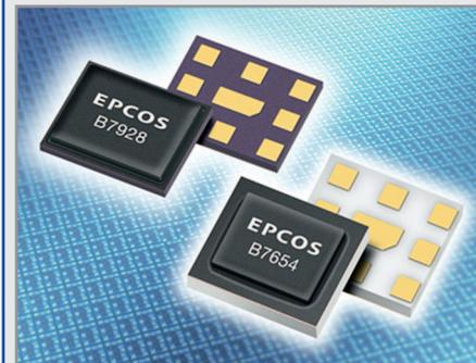
Дуплексеры типа B7654 рассчитаны в режиме передачи (TX) на диапазон частот 824...849 МГц, а в режиме приёма (RX) – на диапазон 869...894 МГц. Между передающим и приёмным диапазонами достигнута развязка 57 дБ. Мешающие GPS-частоты подавляются на 40 дБ.
