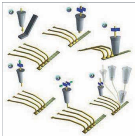
Рис. 2. Схема процесса микросварки методом «шарик-шарик»
