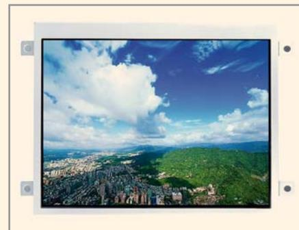
Минимальная яркость свечения существующих стандартных TFT-дисплеев RFC57AD и RFC57AE около 380 кд/м<sup>2</sup>, новые модели характеризуются минимальным значением яркости 800 кд/м<sup>2</sup> и разрешением 320 × 240 пикселей. Дисплеи оснащены цифровым интерфейсом управления.
