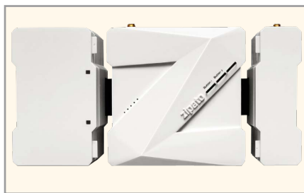
Рис. 2. Контроллер узла сети Zipato с Backup-модулем и с KNX-модулем
