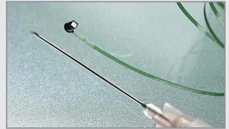
Площадь слоя датчика изображения равна всего 1 мм. Поверх этого слоя установлен объектив, а общий размер камеры равен 1 мм<sup>3</sup>. Это самая миниатюрная камера из всех, изобретённых ранее, и она не больше крупинки соли.
