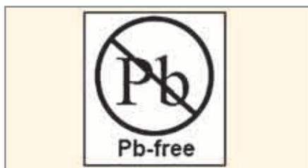
Рис. 1. Маркировка упаковки компонентов, не содержащих свинца
