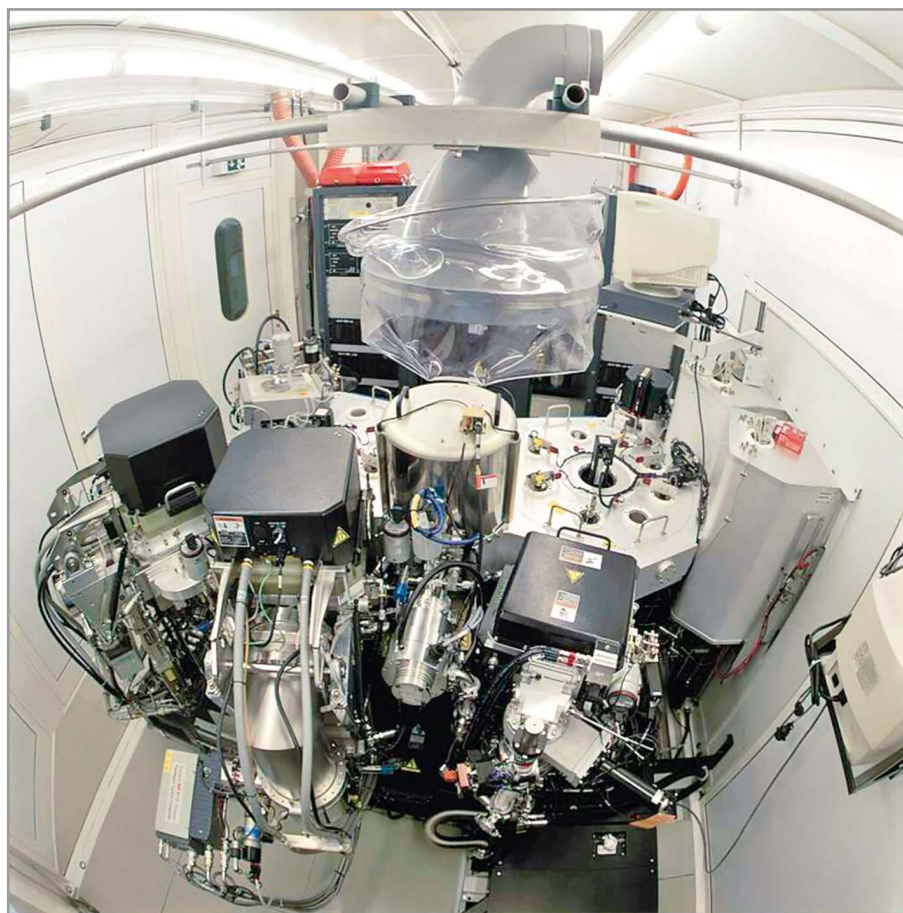
Рис. 1. Установка для формирования слоёв металлизации микросхем ENDURA PVD компании Applied Materials (США)
