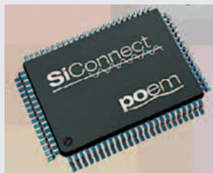
С помощью Peer-to-Peer-разводки Роет должна покрыть все имеющиеся в доме розетки. Качество каждого отдельного соединения всегда известно каждому узлу в сети, который может также служить как усилитель. Новые узлы авторизуются автоматически. Поддерживается до 255 сетей, из которых каждая в свою очередь может иметь до 255 узлов.
