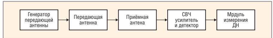
Рис. 2. Структурная схема измерения ДН антенны
