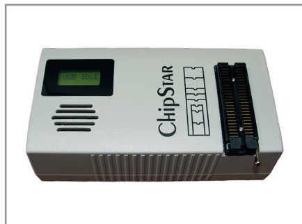
Рис. 4. Программатор ChipStar MT/MT+ для изделий специального и двойного назначения
