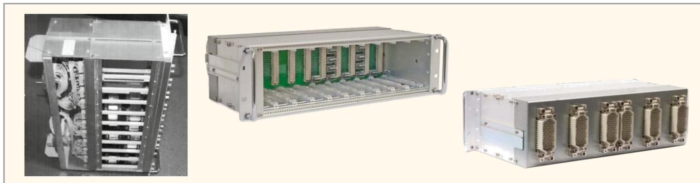
Рис. 7. Релейный блок на основе возможности прямого соединения без проводного монтажа, от оригинала (слева) к готовой разработке
