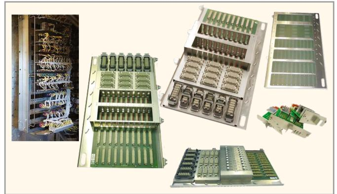
Рис. 5. Объединительная плата с разъёмами DIN 41 612 тип F и HARTING Nap, от оригинала (слева) к готовой разработке
