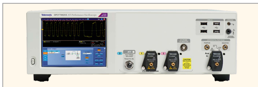
Рис. 13. Внешний вид осциллографа Tektronix DPO77002SX 70 ГГц АТИ
