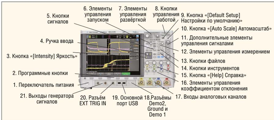
Рис. 2. Назначение органов управления на передней панели осциллографа Agilent серии 4000X
