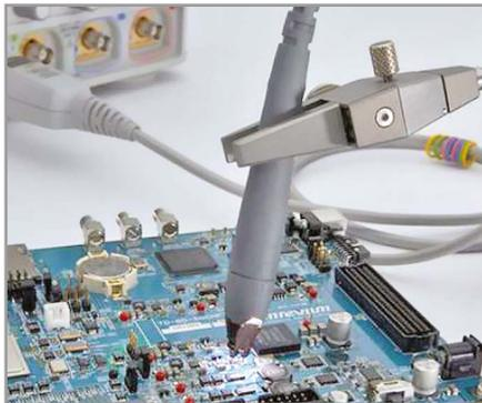
Рис. 4. Подключение осциллографа к тестируемой печатной плате через пробник с зажимом FreeHand
