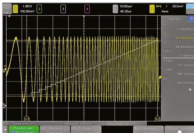
Рис. 19. Осциллограмма сигнала с линейным качением и графиком изменения частоты (белая линия)
