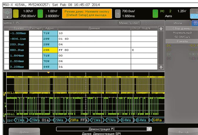
Рис. 21. Анализ последовательной шины данных по протоколу I<sup>2</sup>C
