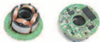
Рис. 6. Статор вентилятора вместе с платой управления
