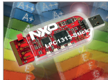
Рис. 3. Оценочный комплект LPC1313-Stick для разработчиков систем на основе микроконтроллеров NXP LPC1300 (включает отладчик HiTOP, компилятор GNU Arm, компилятор Tasking)
