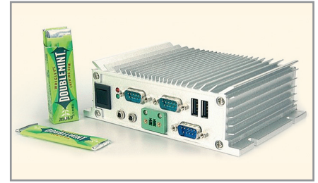
Рис. 1. Системный блок на основе платы EPIAP820 в корпусе AMOS-3001
