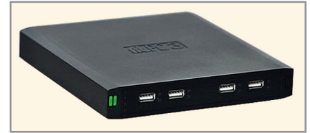
Рис. 3. Системный компьютерный блок fit-PC3 на базе платформы AMD Embedded G-Series
