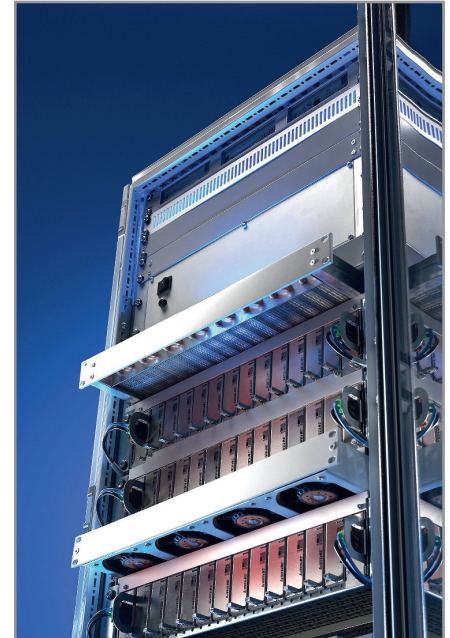
Рис. 8. Стойка системы на базе стандарта MicroTCA в конструктиве Rittal Compact Cooling Package
