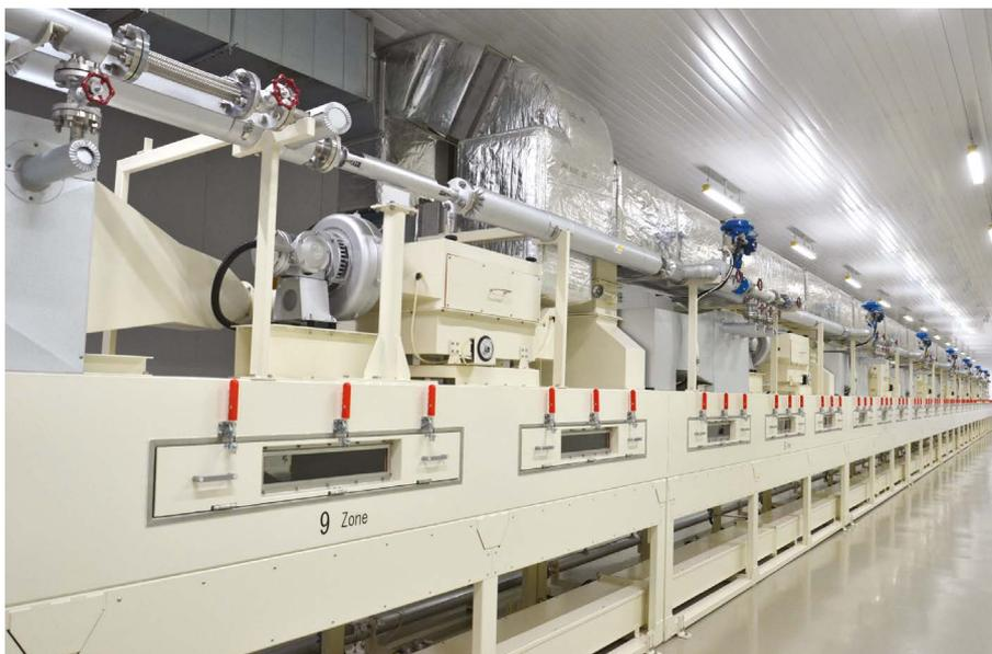
Формообразование керамической плёнки заданной толщины происходит в процессе движения ленты через последовательно расположенные друг за другом зоны сушки, каждая из которых характеризуется своей температурой. С целью обеспечения высокого качества керамической плёнки, стабилизации и обеспечения равномерности коэффициента усадки будущих изделий, на каждую толщину плёнки подбирается отдельный режим сушки.
