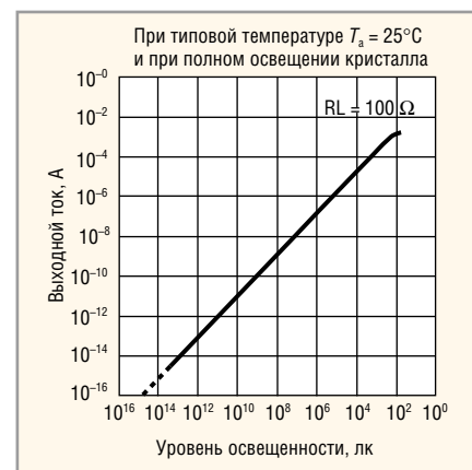
Рис. 6. Зависимость выходного тока фотодиода G1962 от освещённости
