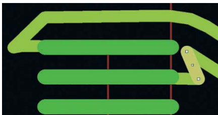
Рис. 12. Ликвидация нарушений после переименования контактов
