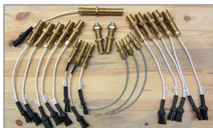
Рис. 2. Общий вид датчиков ДЧХ
