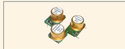
Потребляемая мощность генераторов МХО37 в стационарном режиме в зависимости от рабочего интервала окружающей температуры составляет 120...150 мВт. Время установления частоты после включения генератора (с точностью  $1 \times 10^{-7}$ ) в стандартной версии составляет около 60 с и может быть сокращено до 15 с по требованиям заказчика.
