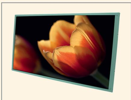
печивает регулировку яркости, контрастности, цвета, положения изображения по горизонтали и вертикали. В комплект поставки модели DLF3245-ENN-A01 входит только драйвер светодиодной подсветки LID32 с соединительным кабелем. По заказу может быть установлен сенсорный экран.
