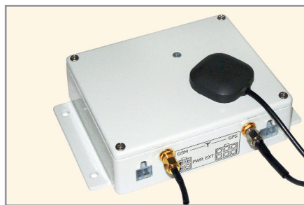
Рис. 1. Внешний вид GPS/GSM-трекера «АГЕНТ В-602»
