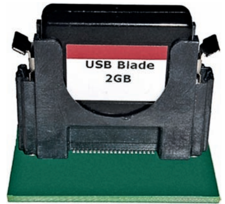
Рис. 1. Твердотельный накопитель в разъёме MiniBlade
