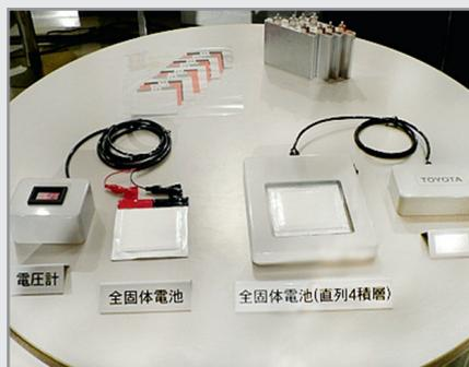
Основным преимуществом твердотельной батареи является высокая выходная мощность, поскольку в идеальных условиях твёрдый литий распространяется быстрее жидкого электролита. Кроме того, твердотельные аккумуляторы гораздо безопаснее по сравнению с использующими органические электролиты, которые горят при высоких температурах. И поскольку
