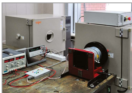
Рис. 7. Поворотный стол с термокамерой
