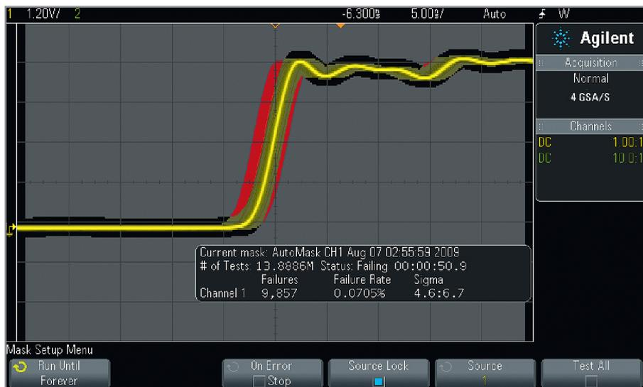
Рис. 2. Тестируемый по маске сигнал с джиттером
