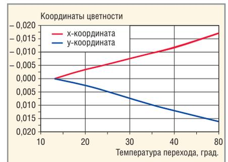
**Рис. 11. Зависимость цветовых координат светодиодов AN424 от температуры**
