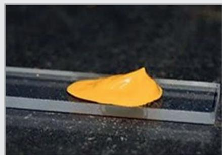
лучила новый светочувствительный материал, способный преобразовывать солнечный свет в электричество. Учёные разработали пастообразную водно-спиртовую смесь из наночастиц диоксида титана и сульфида кадмия.
