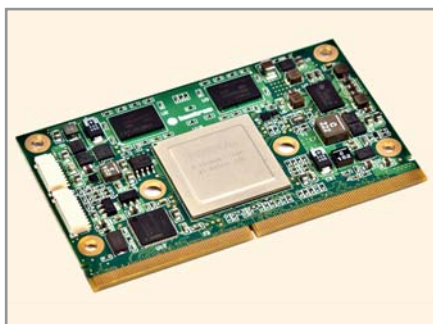
Рис. 6. Модуль стандарта ULP-COM производства холдинга Kontron AG
