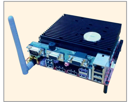
Рис. 4. Носитель «Кена» имеет габариты 150 × 25 × 48 мм и может применяться в устройствах с активным и пассивным охлаждением
