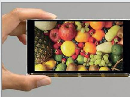
Панель произведена по патентованной технологии HAST (Hyper Amorphous Silicon TFT) и способна отображать картинку с разрешением 1920 × 1080 пикселей. Чтобы достигнуть такого впечатляющего показателя, разработчикам пришлось увеличить «плотность населения пикселей» до 458 на дюйм. Для сравнения, пресловутый экран Retina смартфона iPhone 4 обеспечивает 326 пикселей на дюйм.
