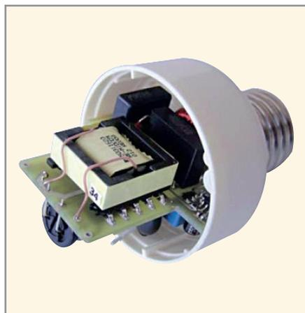
Рис. 3. Установка драйвера в цокольную часть лампы
