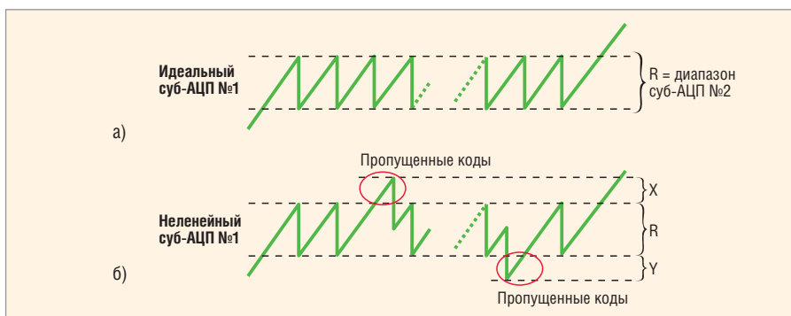
Рис. 12. Временная диаграмма «остатка» на входе суб-АЦП второго каскада
