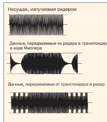
Рис. 14. Виды модуляции, применяемые в mifare-системах
