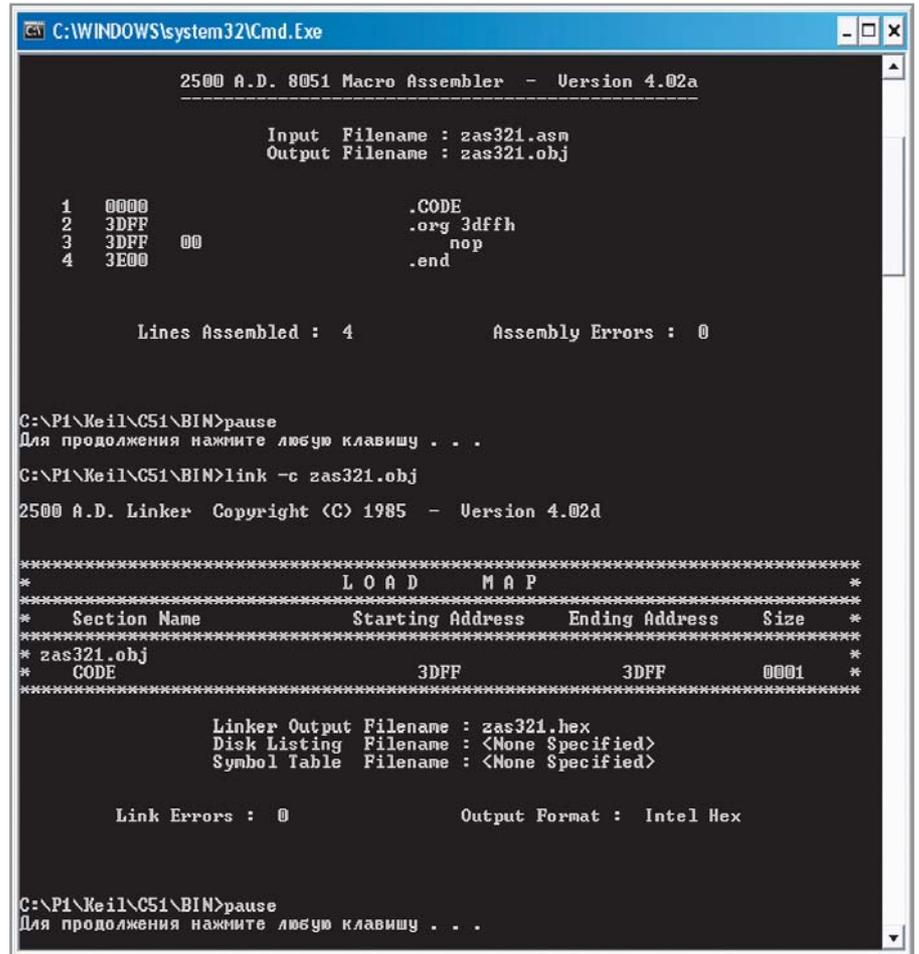
Рис. 1. Результат трансляции программы zas321.asm с помощью файла zas321.bat
