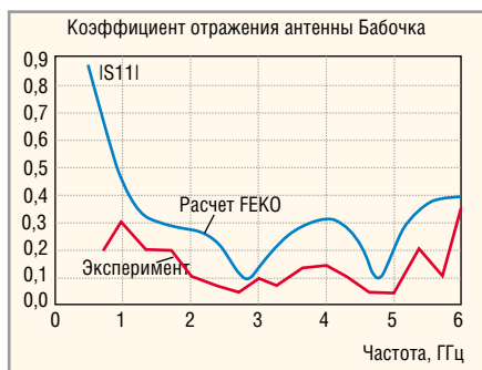
Рис. 6. Коэффициент отражения со стороны входного разъёма антенны «бабочка», отдельные вибраторы которой запитываются с помощью ИС
