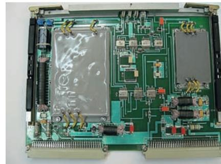
Рис. 3. Ячейка питания мощностью 90 Вт
