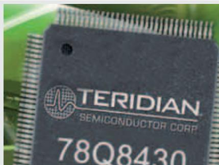
ванную IPChecksum-функцию и 32 Кб конфигурируемой памяти SRAM. Контроллер подключают в сеть к кабелю UTP через согласующее устройство и разъём RJ45.
