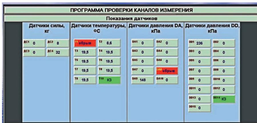
Рис. 6. Экранная форма программы проверки каналов измерения
