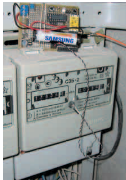
Рис. 4. Внешний вид измерительного устройства, подключённого к счётчику
