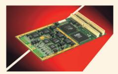
PCI 64 бит/66 МГц. Модуль имеет 10 видеовходов с одновременной компрессией по двум из них и выдачей на шину PCI и два видеовыхода с декомпрессией данных с шины PCI. Программное обеспечение Orion и Orion CC – драйверы для операционных систем Windows, Linux и VxWorks.
