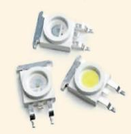
Особенностью ASMT-MY09 является низкопрофильный дизайн и высокий КПД. При мощности 1 Вт и токе 350 мА световой поток достигает 95 Лм. Более того, можно добиться лучшей эффективности Лм/Вт, используя большие управляющие токи. Корпус Moonstone является одним из самых тонких, одновременно в нём эффективно реализован отвод тепла и используется UV-защита из силиконового компаунда для высокой надёжности и длительного срока службы.
