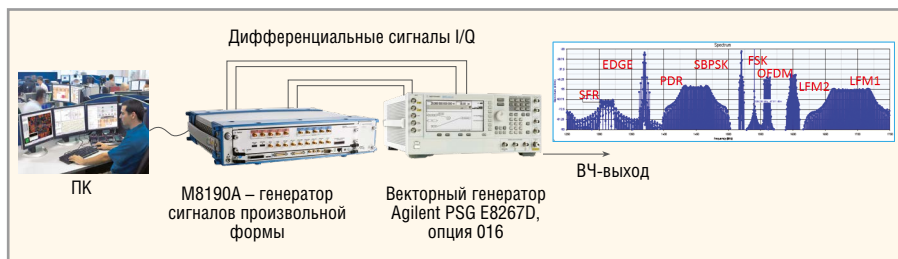
Рис. 4. Сигнал нескольких излучателей (сигналы РЛС и коммуникационные сигналы созданы в платформе для испытаний РЭБ и РЛС на базе САПР Agilent SystemVue)
