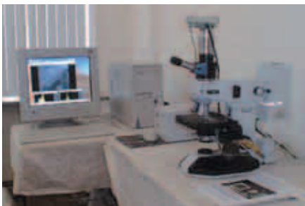
Рис. 7. Флюоресцентный микроскоп, подставка для сканирования объектов, видеокамера и компьютер с нейросетевым программным обеспечением
