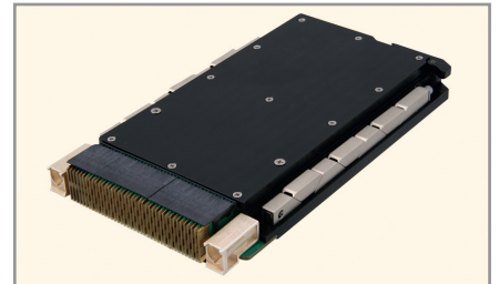
Рис. 3. Модуль Curtiss-Wright VPX3-1100 ATOMIC форм-фактора 3U VPX
