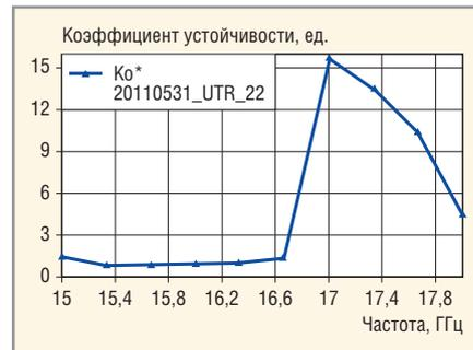
Рис. 10. Коэффициент устойчивости волноводного усилителя с поёрнутыми на 90° отрезками волноводов
