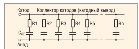
Рис. 3. Эквивалентная схема конденсаторов с объёмно-пористым анодом
