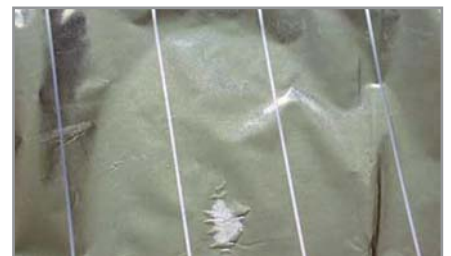
Рис. 7. Пробой диэлектрика в плёночном конденсаторе со структурированным электродом
