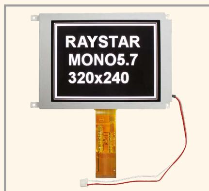
Монохромная модель ЖК-дисплея использует твист-нематические (TN) материалы, но нанесённые на активную матрицу тонкоплёночных транзисторов (TFT), в результате чего достигаются малое время отклика, высокий контраст (800:1) и высокая яркость 1000 кд/м².
