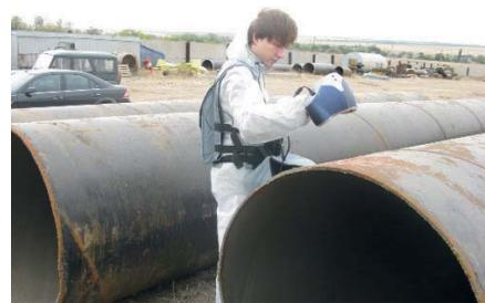
Рис. 3. Сканирование зоны коррозии на трубе
