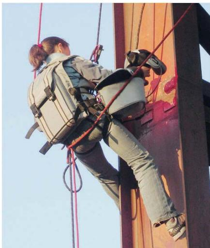
**Рис. 2. Использование сканера с полевым комплектом для инспекции несущих конструкций**
